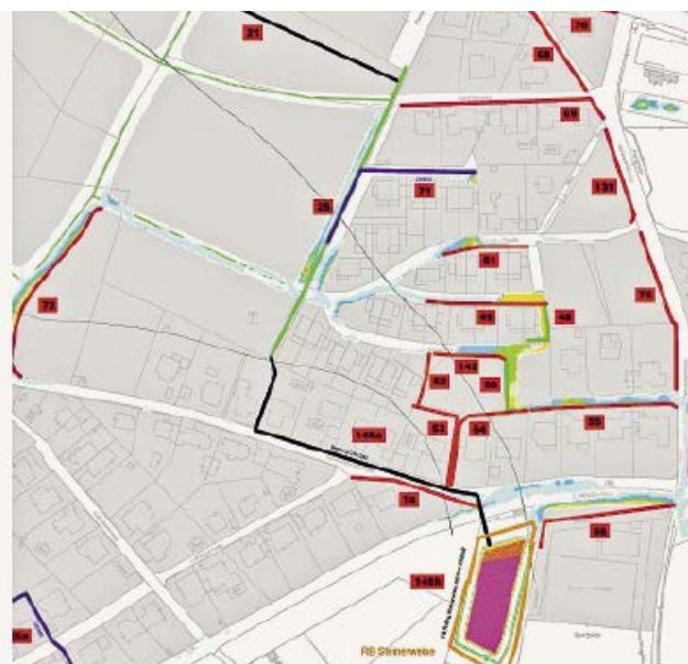
Abb. 7: Sturzflutengefahrenplan mit ausgeschnittenen Gebäuden (links) und geplanter Parzellierung. Sturzflutenmaßnahmenplan mit eingetragenen Maßnahmen, infolge der eingefriedeten Grundstücke erfolgt Abfluss nur auf den Straßen. Legende der Farbdarstellung wie bei Abbildung 6
