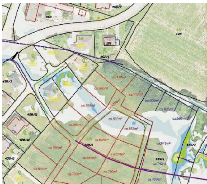
Abb. 7: Sturzflutengefahrenplan mit ausgeschnittenen Gebäuden (links) und geplanter Parzellierung. Sturzflutenmaßnahmenplan mit eingetragenen Maßnahmen, infolge der eingefriedeten Grundstücke erfolgt Abfluss nur auf den Straßen. Legende der Farbdarstellung wie bei Abbildung 6
